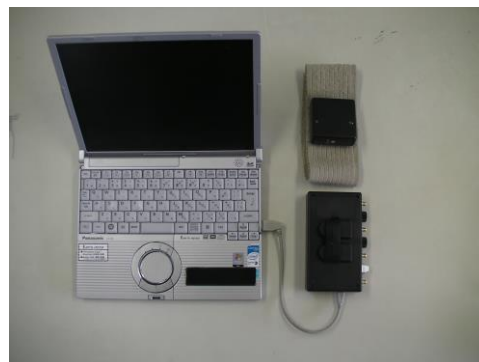
図3 計測に用いた加速度センサ、受信機、PC
