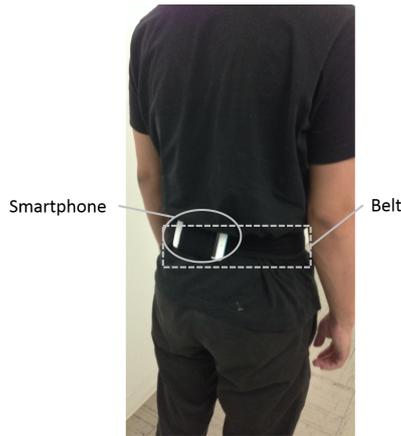
図6 腰の後額面へのスマートフォンの装着の様子
